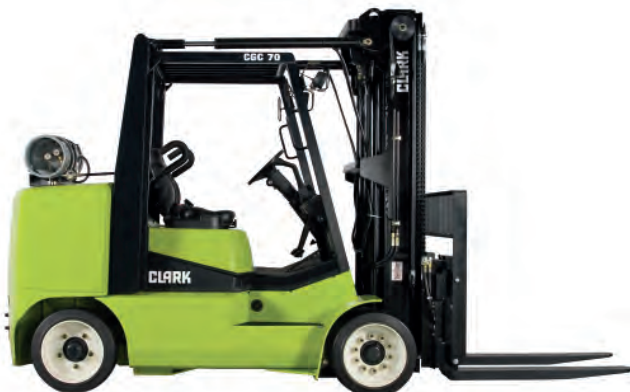
CGC40/50/55 und CGC60/70 LPG Gabelstapler mit Verbrennungsmotor Cushion-Bereifung 40 45 55 60 70 4000 4500 5500 6000 7000 kg
